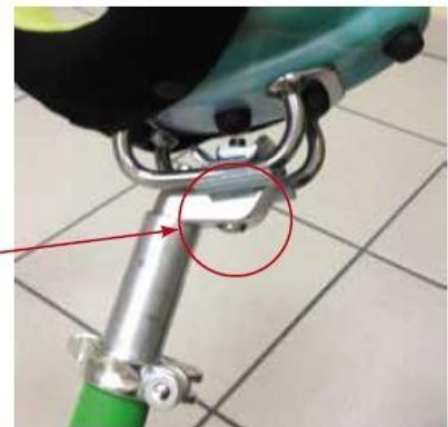
Einstellschraube der Sattelbefestigung
